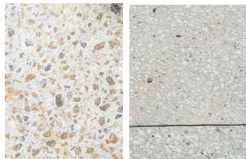
Béton poncé type cyclopéen
